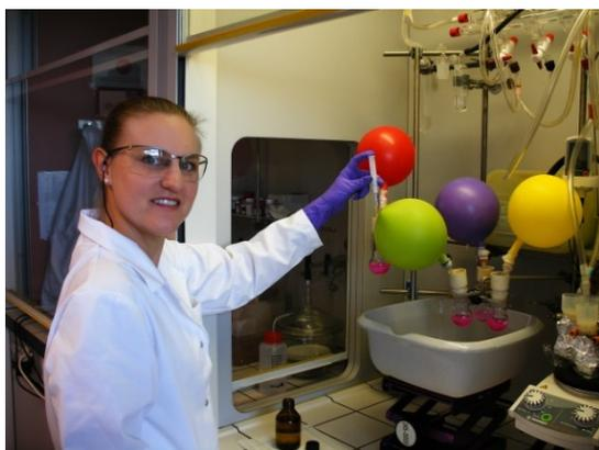
Im Empa-Labor wird die Membran mit Spiropyran funktionalisiert und dadurch «schaltbar» gemacht.
