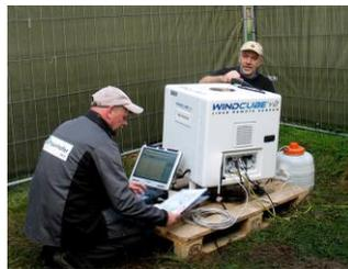
Mitarbeiter des Fraunhofer IWES bei der Inbetriebnahme des LiDAR-Systems: Kompakte und mobile lasergestützte Windmessung, die es ermöglicht, ohne Mast bis in 200 m Höhe über Grund die Windgeschwindigkeit zu messen
