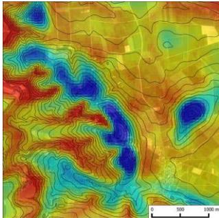
LiDAR-Fehlerkarte: Rote und blaue Bereiche stehen für große messprinzipbedingte Abweichungen
