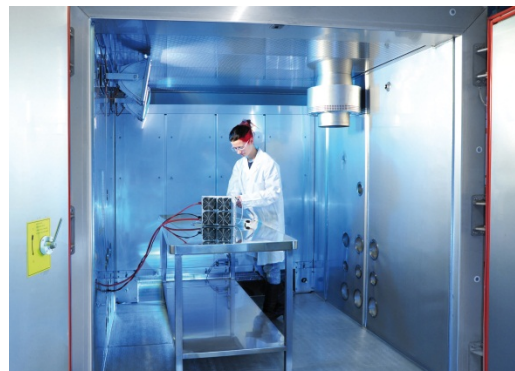
Begehbare Klimakammer für den Test von Brennstoffzellenstapeln und -systemen. © Fraunhofer ISE
